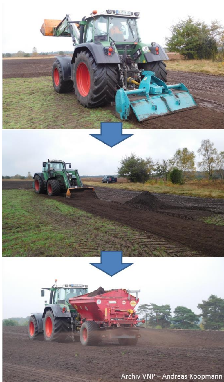
Abbildung 7: Aufnahme und Transfer von Oberboden im Rahmen der unterstützten Wiederetablierung von Segetalarten. Die Arbeitsschritte sind von oben nach unten dargestellt. Nachdem der Oberboden mit einer Fräse aufgelockert wurde (oben), wurde das Spendermaterial mit einer Frontladerschaufel aufgenommen (Mitte). Die Ausbringung am Zielort erfolgte mit Hilfe eines Großflächenstreuers (unten).
